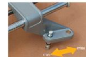
Переход с минимального на максимальный размер дисков осуществляется простой перестановкой "когтей".
