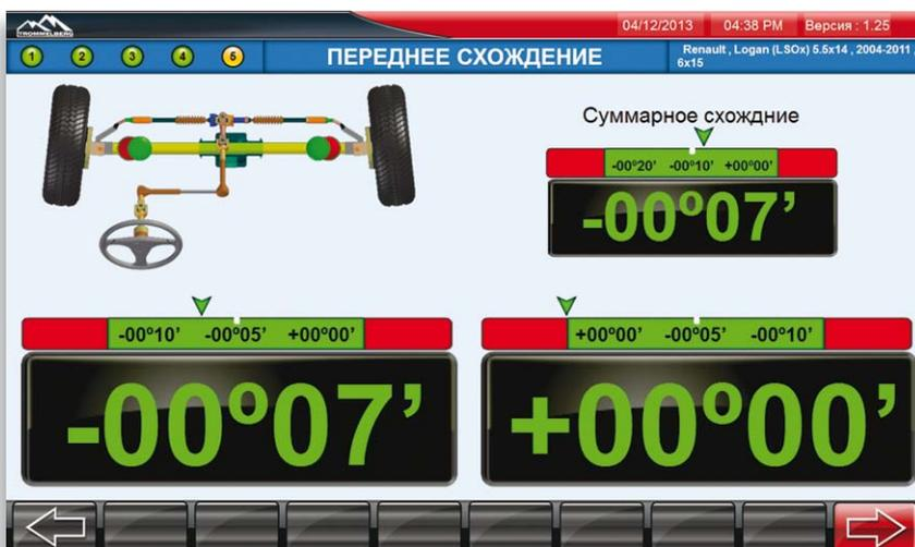
Позволяет регулировать переднее схождение на автомобилях путем независимой регулировки рулевых тяг каждого колеса. Использование данной процедуры обеспечивает достижение нужных показателей схождения и позволяет добиться нужного положения руля без повторной регулировки или исправления регулировок.
