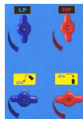
6.1.7.15. Нажмите кнопку «Ввод» для запуска вакуумирования шлангов ВД и НД и системы магистралей. Стрелки манометров ВД и НД повернутся против часовой стрелки в положение между 0 и -1. Показания манометра емкости не изменятся.
