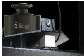
7.3.1.20. Нажмите кнопку «Ввод». Первая строка отобразит вес всей нагрузки на весы, вторая строка отобразит вес груза.
