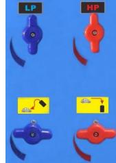
6.3.5. Нажмите кнопку «Ввод» для запуска вакуумирования шлангов ВД и НД и кондиционера автомобиля. Стрелки манометров ВД и НД повернутся против часовой стрелки и окажутся в интервале от 0 до -1. Показания манометра емкости с хладагентом не изменятся.
