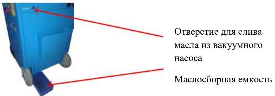
7.1.4. Открутите пробку сливного отверстия вакуумного насоса, отработанное масло потечет в маслосборную емкость.
